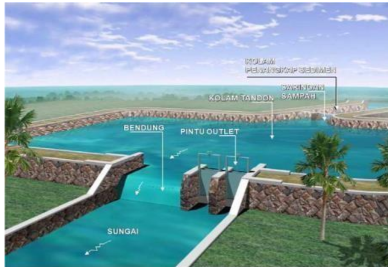
Gambar 7. Kolam Retensi di Dalam Badan Sungai
